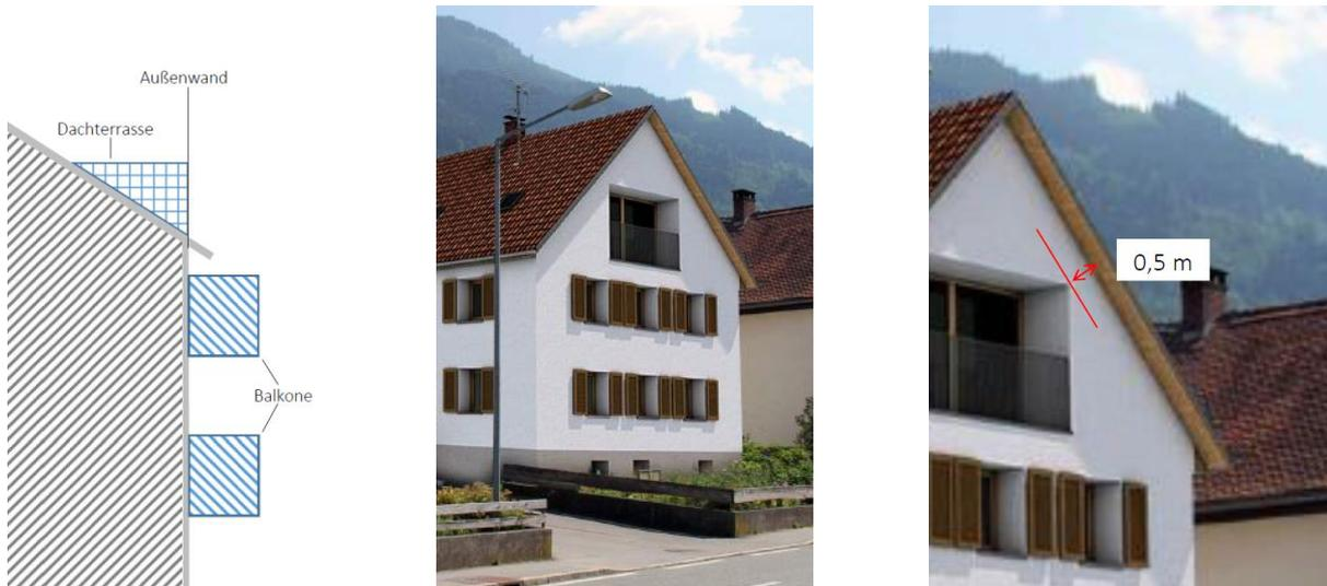
Loggien in der Giebelfassade des Dachgeschosses sind nach dem folgenden Muster (d.h. die Loggia hält einen deutlichen Abstand zur Dachunterkante, die Brüstung verläuft geradlinig entlang der Gebäudeaußenkante, es erfolgt keinerlei Betonung der Abgrenzungen z.B. durch einen Bogen, zusätzliche Materialien oder Farbgestaltungen) möglich, dabei darf die Brüstung nicht in Glas ausgeführt werden.
